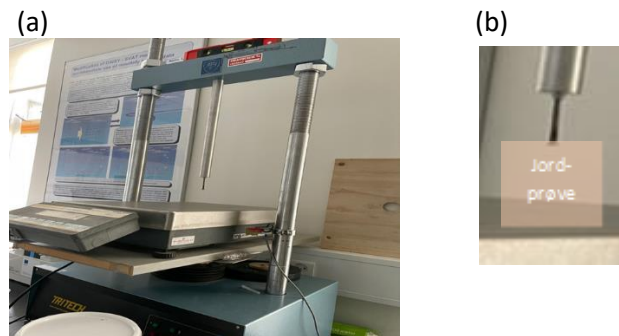
Figur 1. Udstyr til måling af penetrometermodstand i jordprøver. Udstyret består (a) af en elektronisk vægt på et ”bord”, som kan forskydes opefter med meget veldefineret hastighed mod et fastmonteret penetrometer-”spyd” (herefter kaldet penetrometer). Med en jordprøve anbragt på vægten som vist i (b) kan man måle penetrometermodstand som funktion af dybde i prøven. Yderligere vægt kan fordeles ensartet på en cirkulær plade anbragt oven på jordprøven (passende til prøvediameteren og med lille hul til penetrometeret) og derved overføres til jorden, hvorved man simulerer forholdene i større jorddybder med større omslutningstryk. Omslutningstrykket påvirker både forskydningsegenskaber (friktion) og pakningsegenskaber og forventes derfor at påvirke penetrometermodstanden. Der er mulighed for at regulere bordets forskydningshastighed og datalogningen via et dedikeret computerprogram, også mens målingerne foregår.
