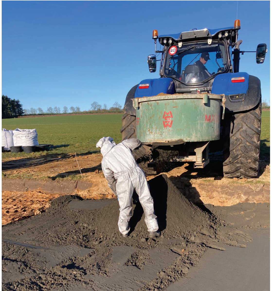
Billede 3: Jord og biokul blev blandet ved hjælp af en betonblandemaskine, inden det blev lagt tilbage i underjorden i 30-80 cm dybde. Foto: Janne Aalborg Nielsen, Seges Innovation.
